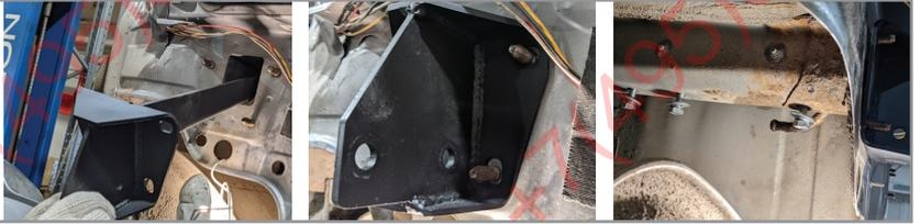
**ШАГ 3.** Установите правый кронштейн крепления аналогичным способом. Закрепите кронштейны на штатных шпильках штатными гайками с фланцем.
