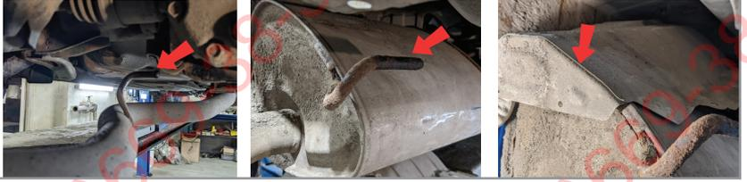
**ШАГ 2.** Установите левый кронштейн крепления, поместив его в отверстие в лонжероне, и совместив штатные шпильки с отверстиями кронштейна. Закрепите кронштейн в лонжероне болтами M10 x 30 x 1,25 через шайбы увеличенные 10 и шайбы гроверные. Соединения не затягивать.
