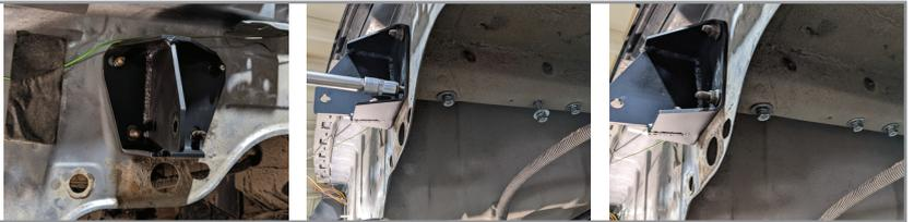
**ШАГ 4.** Установите центральную балку, закрепив её болтами M10 x 30 x 1,25 через шайбы 10 и гроверные шайбы 10. Затяните все соединения! Поставьте задний бампер на место, предварительно вырезав в нём отверстие по прилагаемому шаблону.
