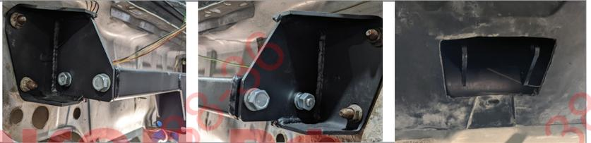
**ШАГ 5.** Установите кронштейн приёмной трубы, закрепив его болтами M12x110x1,25 через шайбы 12, шайбы 12 гроверные с двух сторон и гайки M12 x 1,25. Закрепите кронштейн крепления электрической розетки гайкой M10 с шайбой.
